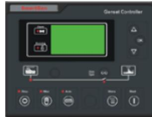
自动化机组控制屏是无人值守自动化机组最基本的配置。该屏能接收远程开/停机组控制信号。(ATS 控制)
